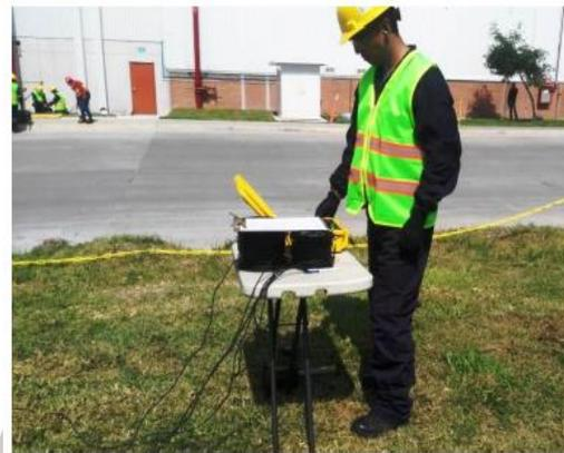
Realizando la Medición de la Resistividad del Terreno en la Superficie de la Subestación Eléctrica CDG3.
