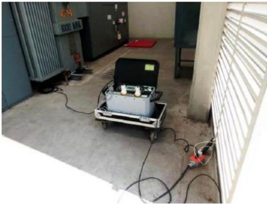
Prueba de Corriente Generada Previo a la Medición de la Tensión de Contacto y Paso. S.E. CDG3.
